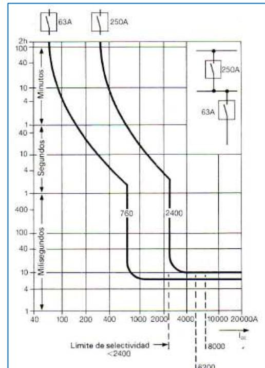
En el ejemplo de la figura 3 la intensidad máxima del cortocircuito que puede producirse en el interruptor de protección principal es de 8,0 kA.
